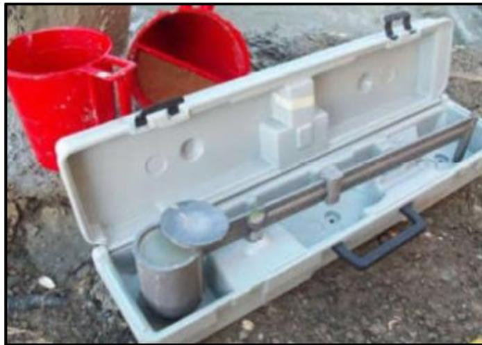
Gambar 3.22. Timbangan Fluida (*Mud Balance*) untuk mengukur berat jenis fluida bor
