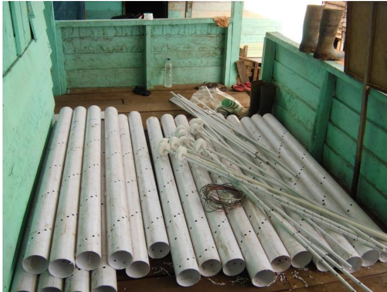
Gambar 1. 2 Bahan-bahan dan Proses Pembuatan Piezometer
